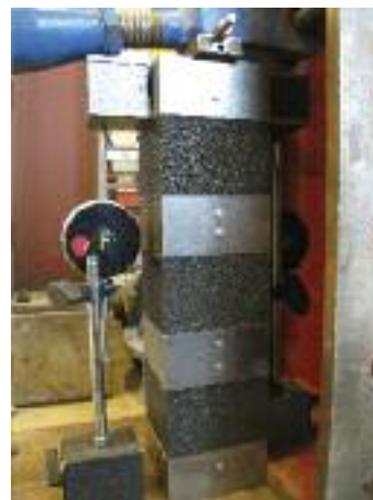
Fig. 4 Essais de compression sur des blocs FOAMGLAS® PERINSUL
