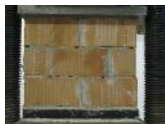
Fig. 6 Essai de compression sur un muret avec maçonnerie en blocs de terre-cuite alvéolés et rupteur de pont thermique
