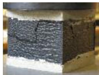
Fig. 1 Charge centrée sur FOAMGLAS® PERINSUL S entre deux lits de mortier
